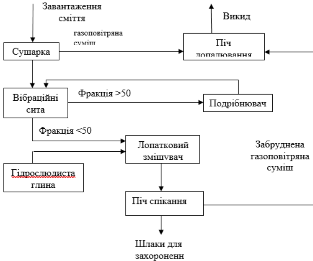
Рис. 1. Технологічна схема переробки сміття
