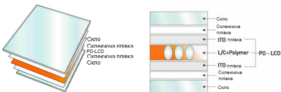
Рис. 2. Конструкція «розумного» скла для вікон
