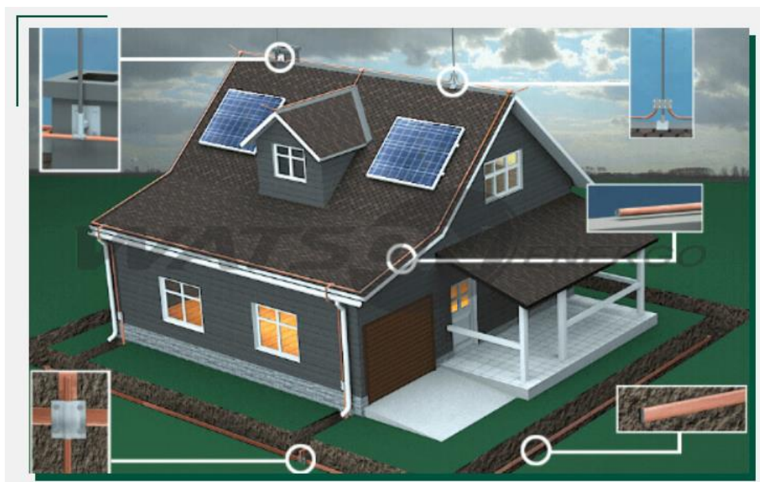
Рис. 1. Зовнішній блискавкозахист Watson-energo приватного будинку: блискавкоприймач у вигляді двох стрижнів; струмовідвід у вигляді мідної полоси, яку в двох місцях під'єднано до стаціонарного захисного заземлення, розміщеного по периметру будинку.
