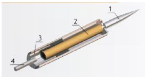
Рис. 5. Конструкція блискавкоприймача Gromostar: 1 – наконечник блискавкоприймача; 2 – високовольтна система (котушка індуктивності); 3 – генератор імпульсної напруги та іскровий зазор; 4 – з'єднувальна муфта М16
