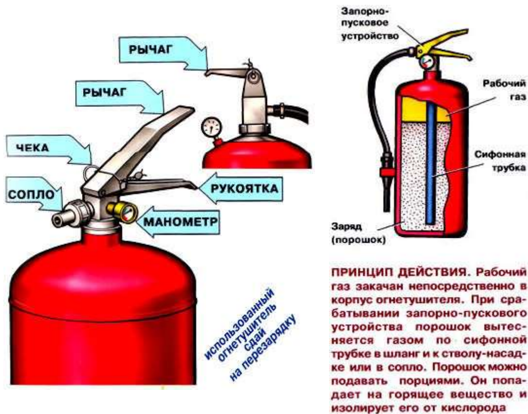
Рисунок 1. Конструктивна схема порошкового вогнегасника
