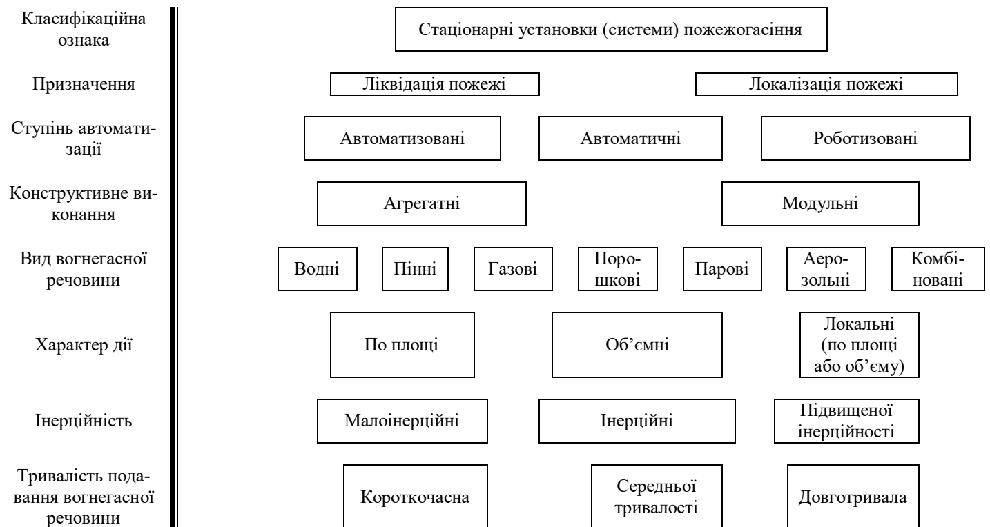
Рис. 8. Класифікаційна схема стаціонарних установок (систем) пожежогасіння
