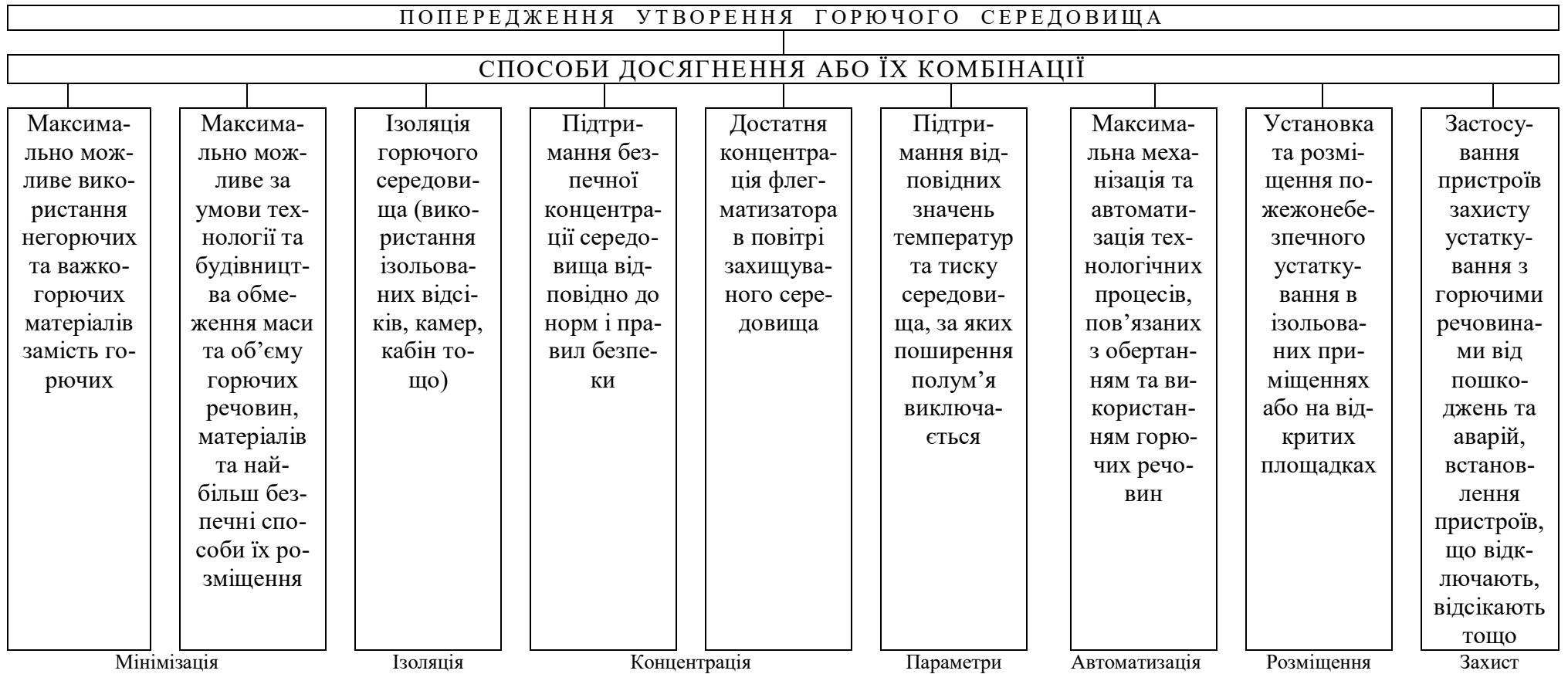
Рис. 3 . Схема забезпечення попередження утворення горючого середовища
