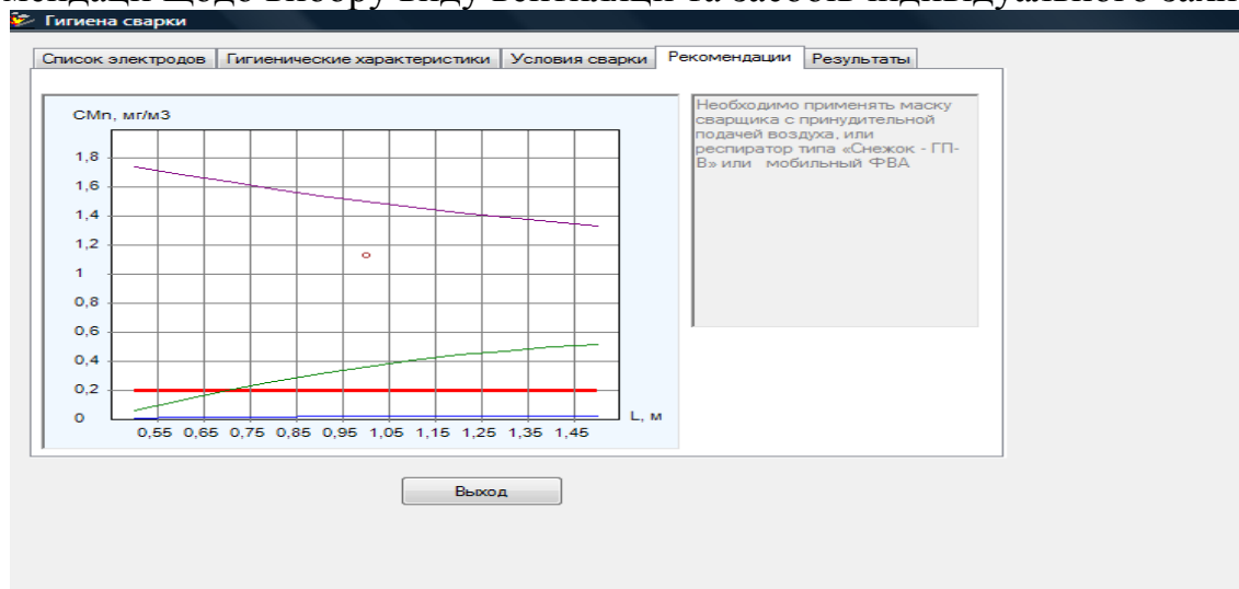
Рис. 3. Результат і рекомендації щодо вибору виду системи вентиляції і (або) засобів індивідуального захисту органів дихання за допомогою інформаційно-розрахункової системи «Гігієна зварювання»
