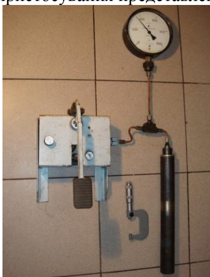
Рис. 2. Гідравлічне пристосування, де: 1 – гідронасос, 2 – манометр, 3 – труба, 4 – мікрометр
