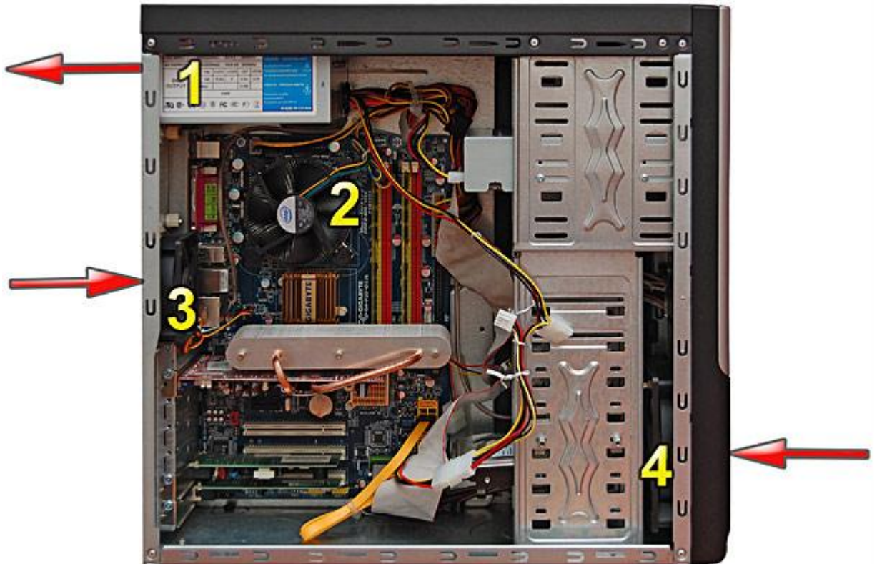
Рис. 1. Напрями руху повітря в системних блоках:
